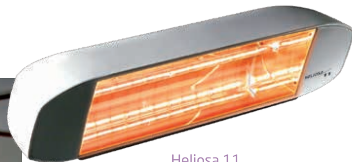
Heliosa 11 2000 W, IP20 (11B20) Visina instalacije 1,90-2,20 m Grejna površina 12-15 m 2 Dimenzije 45,5x13x9 cm
